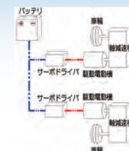
【電動モノレール点検車システム概略】
