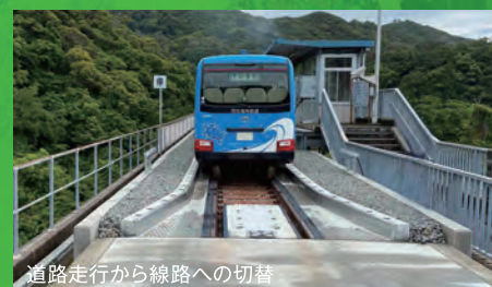
道路走行から線路への切替
